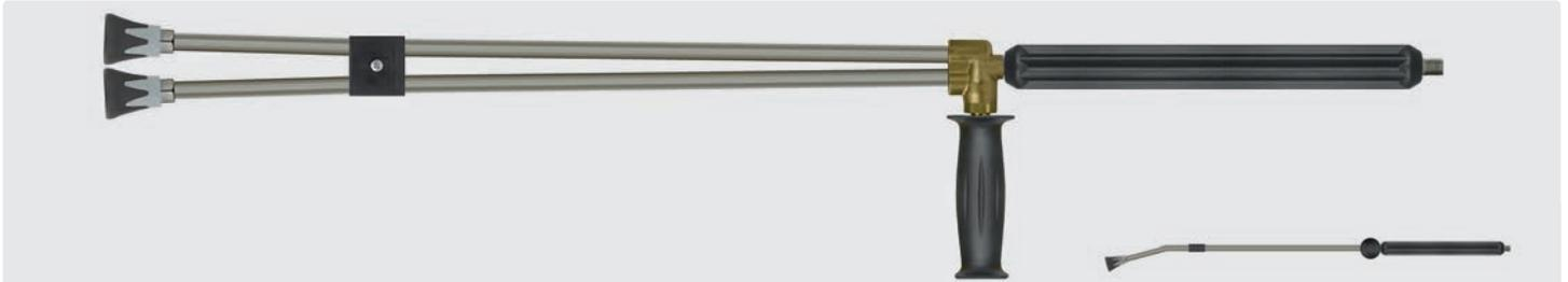
1/4" AG. Strahlrohr mit umspritzter Isolierung, Ventil ST-54 und Düsenschutz ST-10 mit Niederdruckdüse & Muffe 1/4" IG. Max. 310 bar / 150 °C
