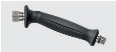
Edelstahl. Handgriff 20° abgewinkelt. Max. 350 bar / 150 °C
