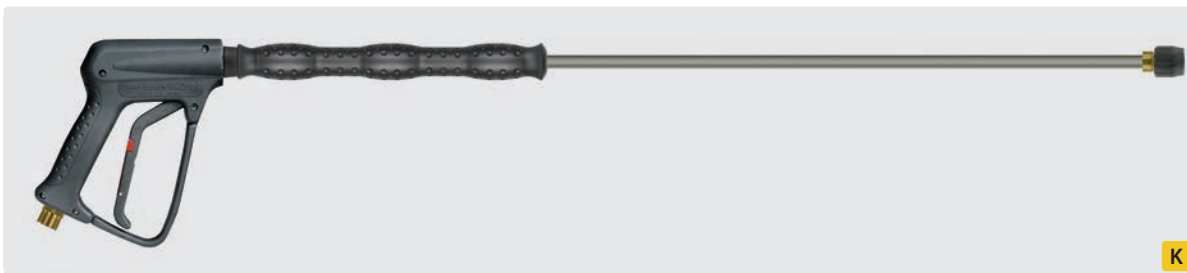
Professionelle Pistole R+M EcoLine No. ONE mit Strahlrohr 900 mm Stahl verzinkt, Isolierung ST-28 Cool & Compact 300 mm und Düsenschutz ohne Mundstück. Max. 250 bar / 45 l/min / 150 °C
