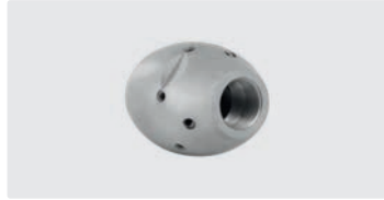
3/8" IG. 6x 75° 3x 30° +1x 0°. 30-100 l/min. Für \text{R} \varnothing 100-200 mm. Außen \varnothing 35 mm. \text{G} 314 g.
