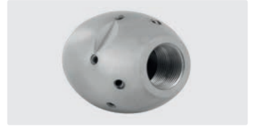
3/4" IG. 6x 75° 3x 30° +1x 0°. 100-250 l/min. Für \text{R} \varnothing 150-300 mm. Außen \varnothing 50 mm. \text{G} 1.367 g.
