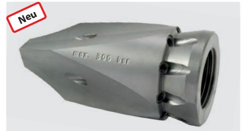
300 bar. 1" IG. \square 100 mm, \varnothing = 50 mm, \boxplus 0,64 kg. Für Rohre > 100 mm. Seitliche Frontstrahlen mit gehärteten Edelstahl Düseneinsätzen.
