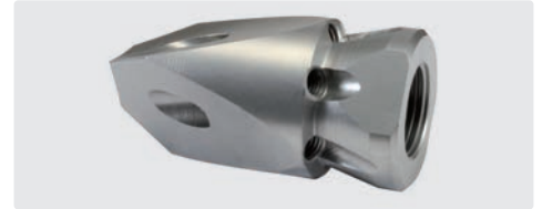
350 bar. 3/8" IG. \square 55 mm, \varnothing = 28 mm, \boxplus 0,13 kg. Für Rohre > 50 mm. Seitliche Frontstrahlen mit gehärteten Edelstahl Düseneinsätzen.
