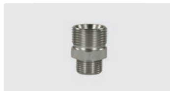
M22 AG : AG. Edelstahl. Max. 500 bar
