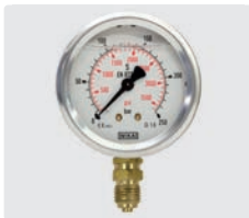
∅ 63 mm. 1/4" AG. Gehäuse Edelstahl. Eingang unten. Typ WIKA
