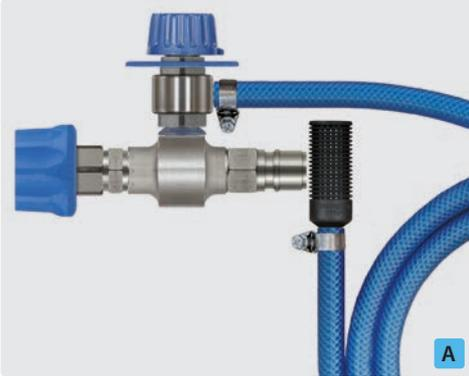
Kupplung ST-45-250 Messing vernickelt : Stecknippel ST-45-250 Edelstahl. Injektor ST-160 mit Dosierventil ST-161, Saugschlauch 2.000 mm und Saugfilter ST-31. Max. 250 bar / 90 °C
