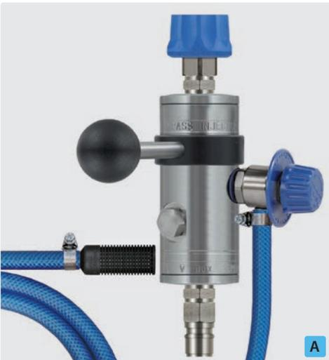
Kupplung ST-45-250 Messing vernickelt : Stecknippel ST-45-250 Edelstahl. Injektor ST-167 mit Dosierventil ST-161, Saugschlauch 2.000 mm und Saugfilter ST-31. Max. 250 bar / 100 °C
