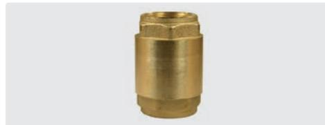
R+M Rückschlagventil. Ventilkegel aus Kunststoff mit Gummidichtung. Schließfeder Edelstahl. Verhindert Rückfluss in jeder Stellung
