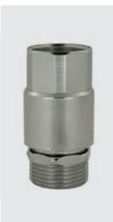
Messing verchromt. Rückflussverhinderer nach DIN 19884 und DIN EN 1717. Damit bei Überdruck in der Wasserleitung kein Reinigungsmittel in den Trinkwasserkreislauf gerät. Vorgeschrieben bei direkter Leitungsverbindung zur Pumpe
