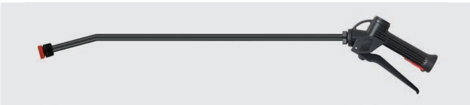
600 mm. Chemiepistole mit Lanze aus Kunststoff und Düsenhalter ohne Düse. Pistole mit säurebeständiger Kugel. Max. 25 bar / 30 l/min / 50 °C
