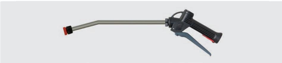
300 mm. Chemiepistole mit Lanze aus Edelstahl und Düsenhalter ohne Düse. Pistole mit chemiebeständiger Edelstahlkugel V4A / AISI 316. Max. 25 bar / 30 l/min / 50 °C
