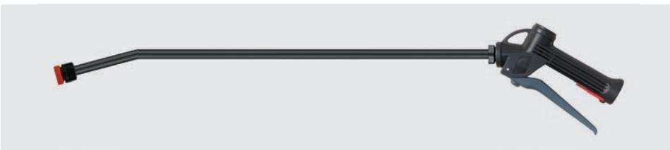
600 mm. Chemiepistole mit Lanze aus Kunststoff und Düsenhalter ohne Düse. Pistole mit chemiebeständiger Edelstahlkugel V4A / AISI 316. Max. 25 bar / 30 l/min / 50 °C
